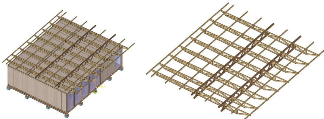
Figura 6. Estructura cubierta superior
